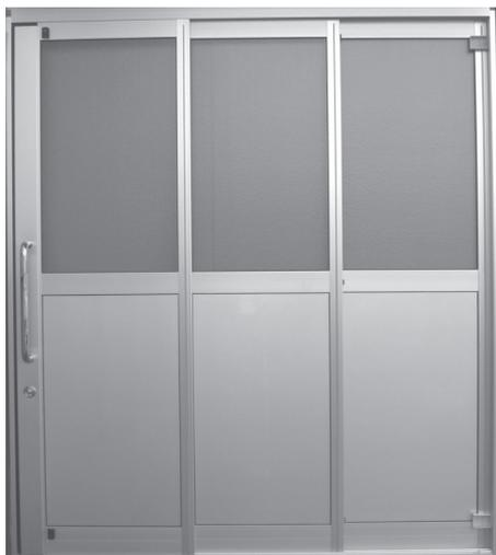
※ 左勝手に変更する場合は、障子吊り込み方法の始めから反対側で行い、A障子シリンダーを内外逆に付け替える。
